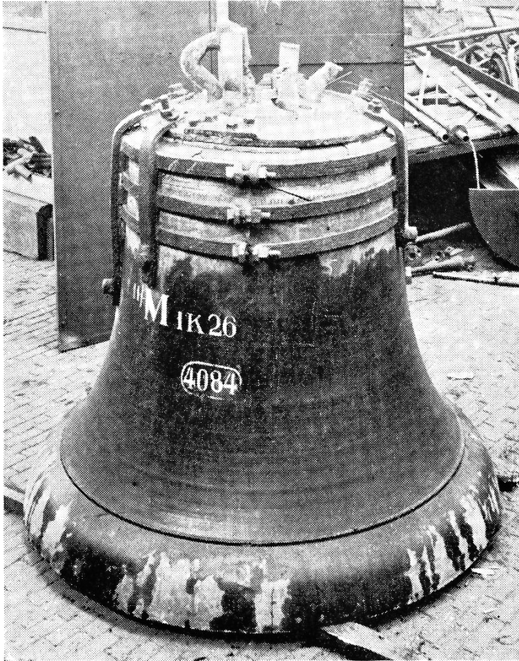
De Catharinaklok van Brielle, in 1946 gefotografeerd bij de Rotterdamse Droogdok Maatschappij. De hoepels rond de schouders houden de brokstukken bij elkaar. De kroon is incompleet.
